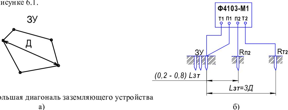
Д - наибольшая диагональ заземляющего устройства
