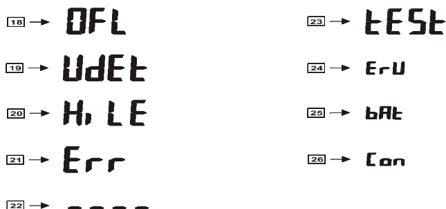
Рис.3. Надписи и символы, отображённые измерителем MIC-3
